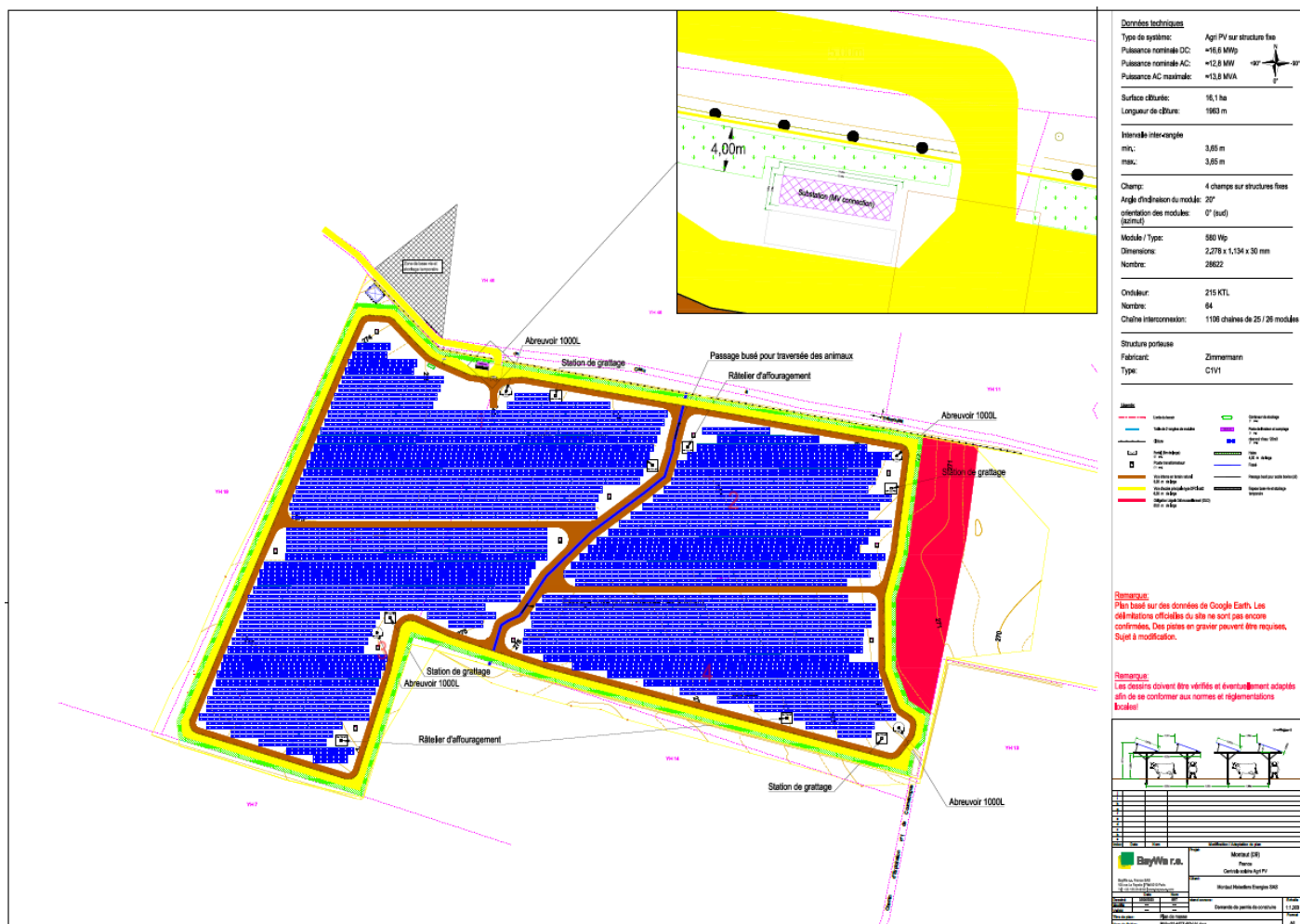
Illustration 49: Schéma du parc agrivoltaïque divisé en 4 paddocks pour mettre en place du pâturage tournant dynamique
